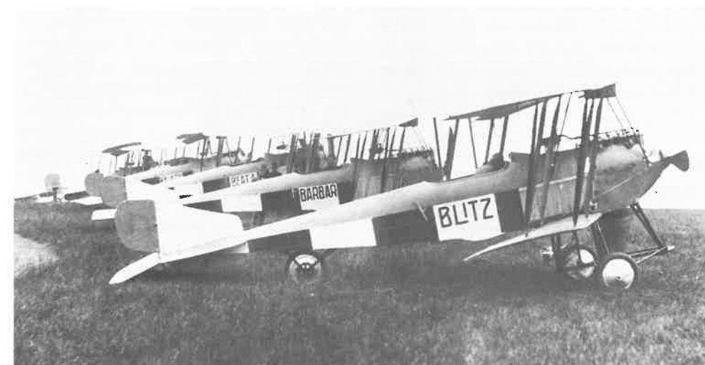
Lohner-Pfeilflieger B, zweisitzig, 90 PS Austro-Daimler- Motor, ca. 100 km/h, Spannweite: 13,5 m.
